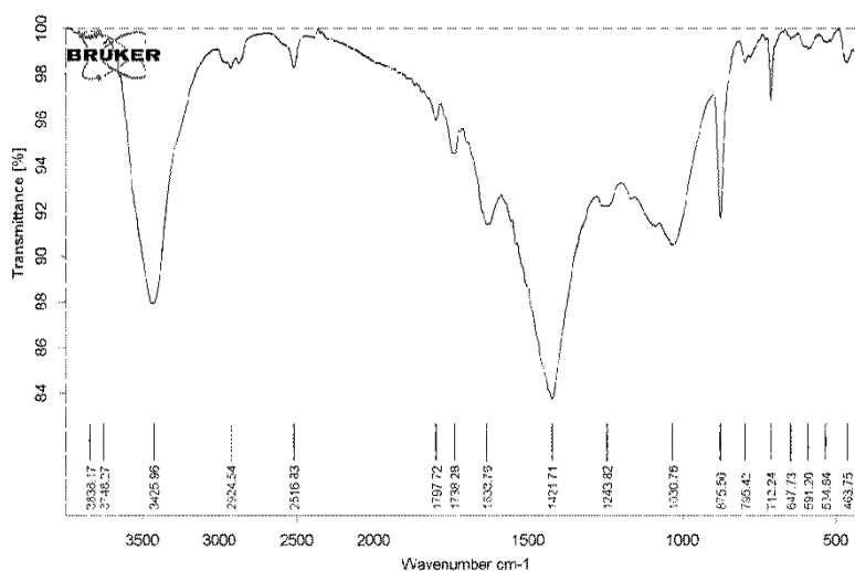
شکل ۲- طیف مادون قرمز ملات پلیمری پلیمورتکس
