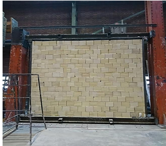
شکل ۴- ساخت دیوار با میلگرد بستر به صورت یک در میان و در یک ردیف مانده به آخر
